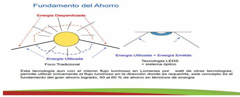
En la siguiente ilustración, nótese la diferencia entre un foco incandescente de 40 watts y una lámpara de LEDS de 20 watts.
