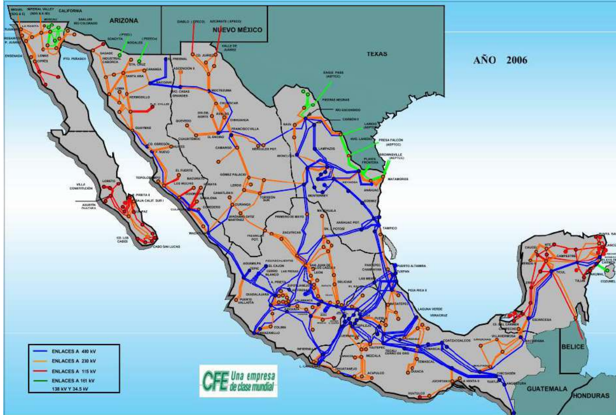
Figura 14. Red troncal del sistema eléctrico mexicano.
