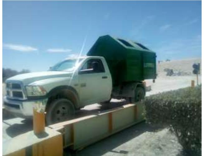
SE REALIZA EL PESAJE EN LA BÁSCULA A TODOS LOS VEHICULOS QUE INGRESAN A DEPOSITAR LOS RESIDUOS SOLIDOS EN EL RELLENO SANITARIO (PESAJE ENTRADA Y SALIDA DEL VEHICULO PARA REGISTRAR EL PESO NETO DE RESIDUOS SOLIDOS QUE INGRESAN AL RELLENO SANITARIO).
